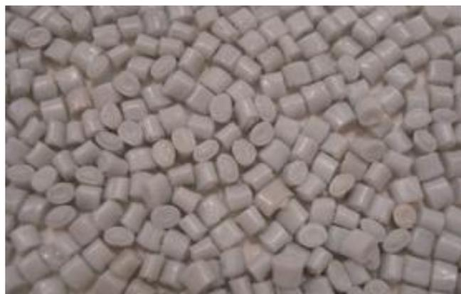
**Figura 15:** Granza obtenida después de procesar los residuos de plástico PET.
